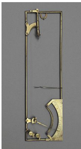
Slika 3: Lasni vlagomer. Danes bi seveda uporabili digitalne higrometre, ki delujejo na upornost[4].
